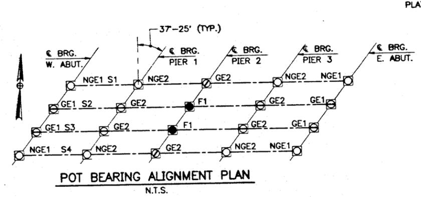
POT BEARING ALIGNMENT PLAN
