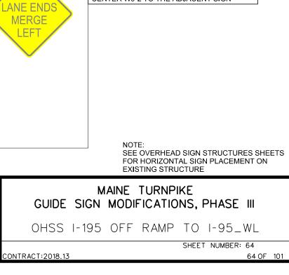
INSTALL NEW W9-2 SIGN TWO FEET AWAY FROM MTA SIGN 6363 ON EXISTING
