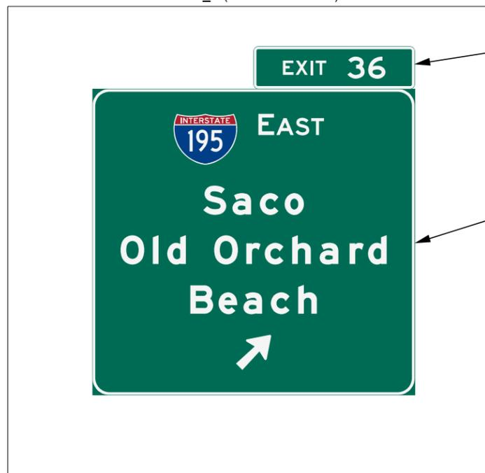
INSTALL EXIT PANEL ON THE TOP OF THE GUIDE SIGN WITH THE RIGHT EDGES ALIGNED
