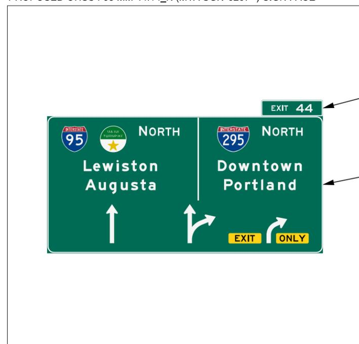
INSTALL EXIT PANEL ON THE TOP OF THE GUIDE SIGN WITH THE RIGHT EDGES ALIGNED
